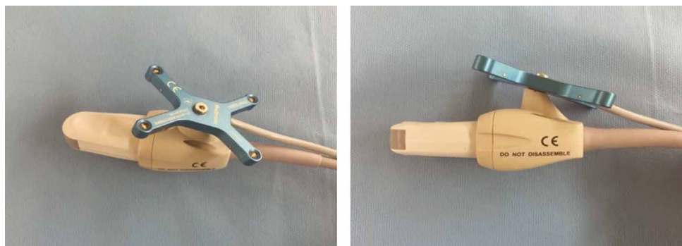
Рис. 2. Линейный датчик автономной УЗ-станции с предустановленным навигационным зондом — Sono Nav M-Turbo. Fig. 2. The linear sensor of the autonomous ultrasound station with a pre-installed navigation probe is Sono Nav M-Turbo.
