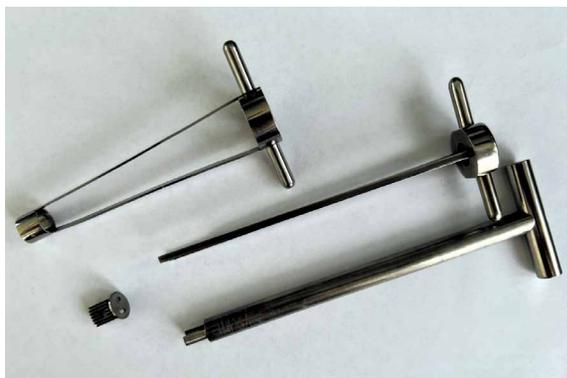
Рис. 7. Держатель модели импланта с цанговым механизмом в разобранном виде.
