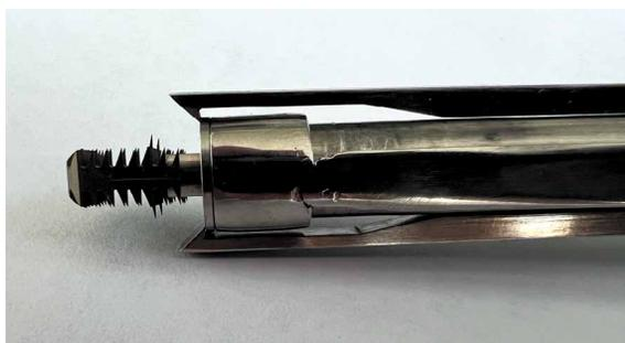
Рис. 6. Захват и удержание кейджа цанговым механизмом.
